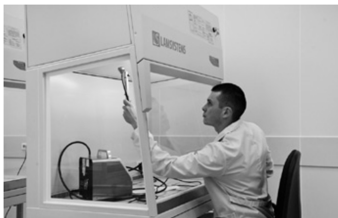
Рис. 2. Проверка целостности HEPA фильтра счетчиком аэрозольных частиц
