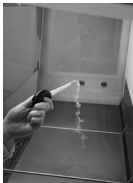
Рис. 3. Визуализация движения потоков воздуха с помощью генерации дыма
